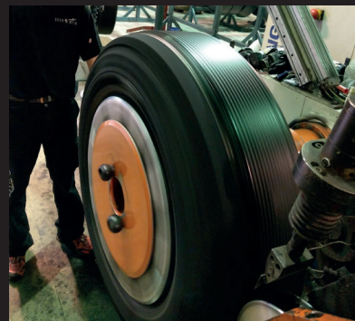
Ekstrudering av ny gummi på varmvulk.
