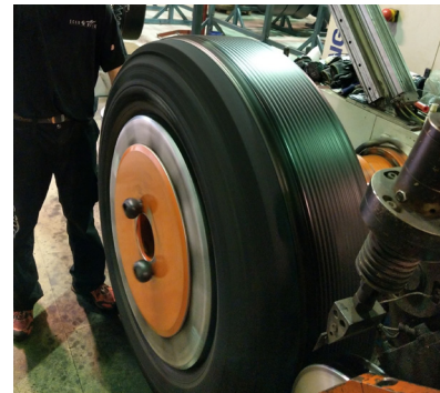
Ekstrudering av ny gummi på varmvulk.
